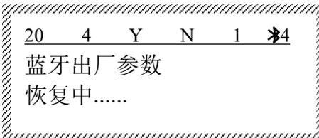
蓝牙恢复出厂参数中时间，控制在 5 秒内，完成后，屏幕显示：
