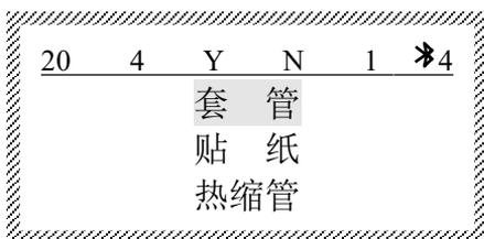
选择**套管**，按【Enter】，进入套管规格选择界面，屏幕将显示：
