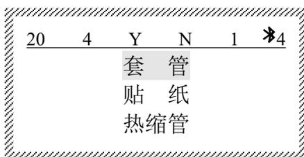
5.2.2.按【↑】、【↓】，选定套管，按【Enter】键，再用【→】、【←】选定材料具体型号后再按【Enter】，进入文档输入界面。
