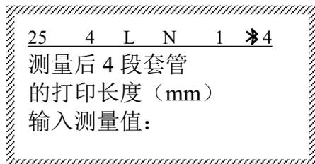
例如：实测打印物的后4段总长度为98.5mm，将“98.5”输入后，按【Enter】即可。
